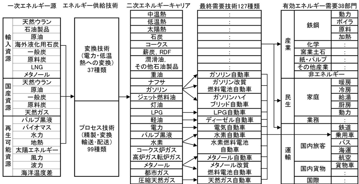
図1 モデル化したエネルギーシステムの概要
